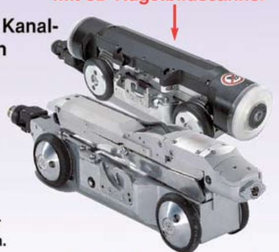
2. Kamerasystem "Panoramo" mit 3D-Kugelbildscanner
