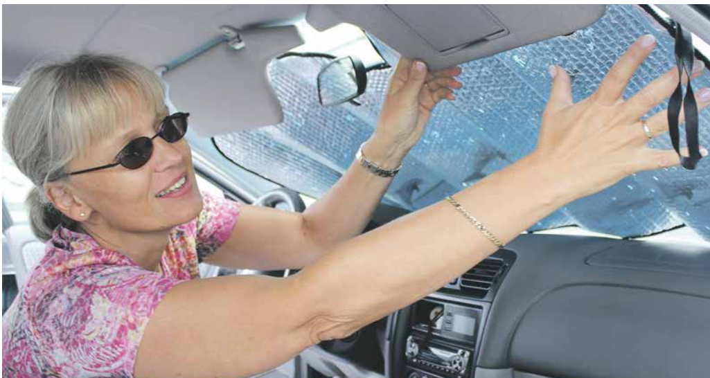
Eine einfache Sonnenschutzfolie reflektiert das Sonnenlicht und das geparkte Auto heizt sich nicht so stark auf.
